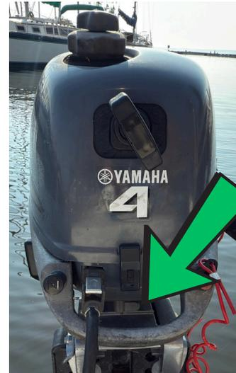
Vérifiez que le levier de vitesse est au point mort (N) et que le clip de l'interrupteur d'arrêt d'urgence est en place.
